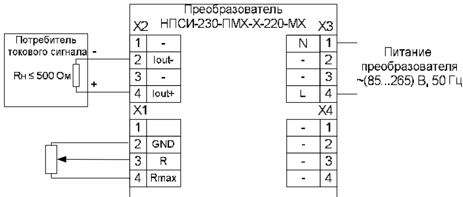
Рисунок 4 – Электрическая схема подключения преобразователя НПСИ-230-ПМХ-Х-220-МХ
